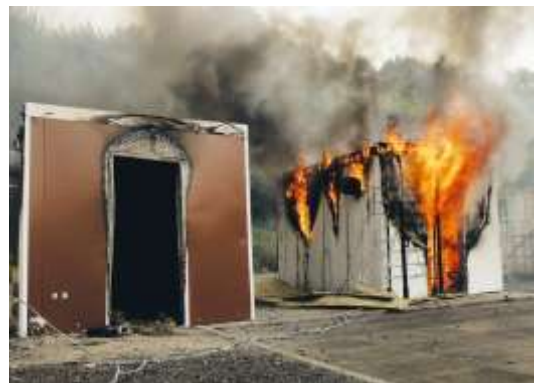
Efter 45 minutter trænger der røg igennem deformerede samlinger i stenuldshuset.
