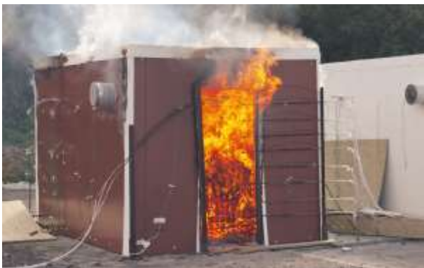
Efter 25 minutter er branden brudt igennem PIR-elementerne adskillige steder.
